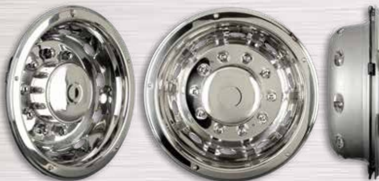
Art. 9812 Radzierblende Antriebsachse (zwillingsbereift) mit aufgesetzten Radmutterkappen, ausschließlich für zwillingsbereifte Antriebsachsen Nabenabdeckung Ø 220 mm, Höhe 130 mm, Tiefbett 160 mm
