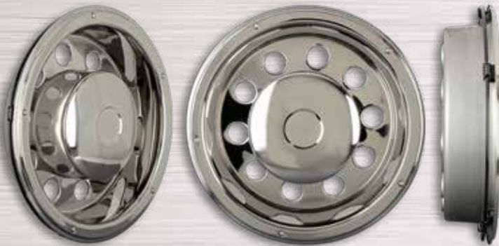
Art. 9806 Radzierblende Antriebsachse (zwillingsbereift) ausschließlich für zwillingsbereifte Antriebsachsen, Nabenabdeckung Ø 280 mm, Höhe 115 mm Tiefbett 130 mm
